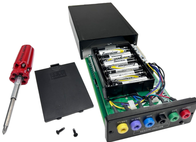
Figure 2.4a Remplacement des batteries
